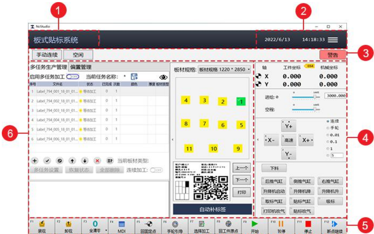
1.系统名称 2.功能按钮栏 3.状态显示栏 4.机床控制栏 5.操作按钮栏 6.加工管理区
